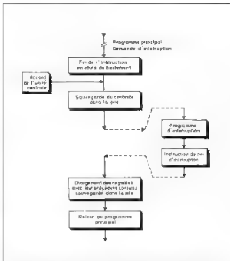
Fig. 1. — Lorsque la demande d'interruption est prise en compte, le programme déjà en cours est interrompu après exécution de l'instruction en cours. Les registres internes du microprocesseur sont sauvegardés dans une zone de la mémoire (la pila) (stack en anglais) et, à la fin de la procédure d'interruption qui s'en suit, à leur tour, le programme principal peut reprendre son cours.
